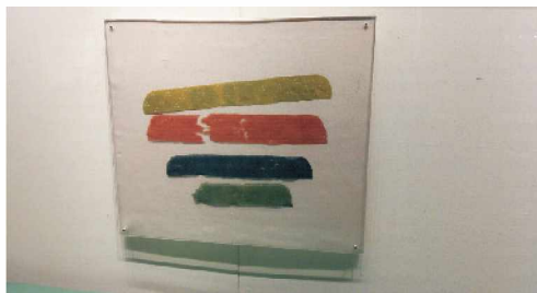
图 7 织物僵硬断裂
