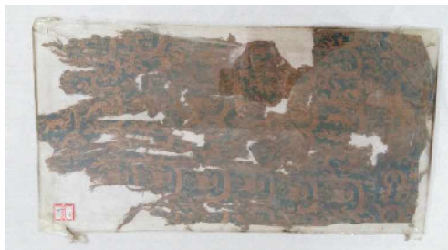
图 8 有机玻璃老化
