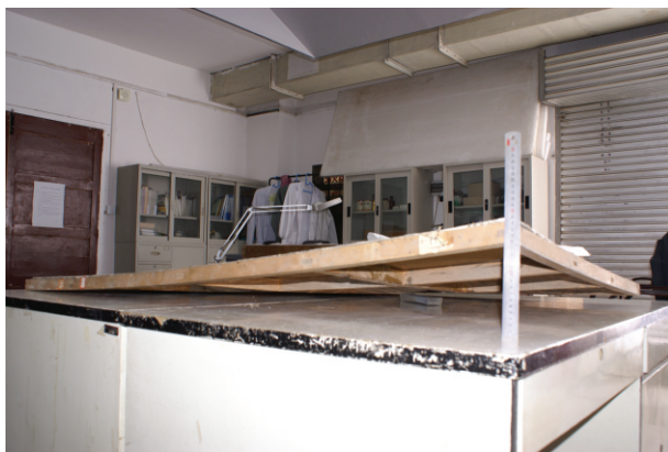
图四 木龙骨支撑体壁画变形病害
