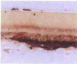
案内面黑色部位涂膜断面 12.5 \mu\text{m} (透过光)
