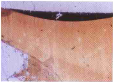
衣盖外面红色部位涂膜断面 50 \mu\text{m} (透过光)
