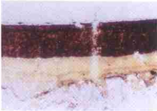
衣盖内面红色部位涂膜断面 25 \mu\text{m} (透过光)
